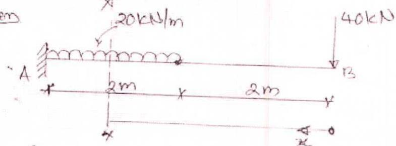
$$EI = 2 \times 10^7 \text{ kN} \cdot \text{mm}^2$$
