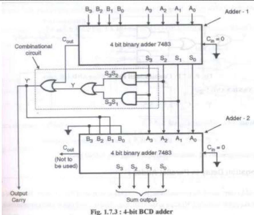
Fig. 1.7.3 : 4-bit BCD adder
