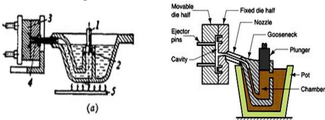
Fig. Hot chamber Pressures die casting
